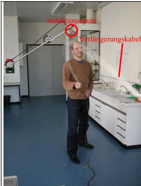
Abb. 1: Durch die Rotation des Verlängerungskabels im Erdmagnetfeld wird darin eine elektrische Spannung induziert. Die Bedeutung der Induktionsspule wird in Abschnitt 3 erläutert.
