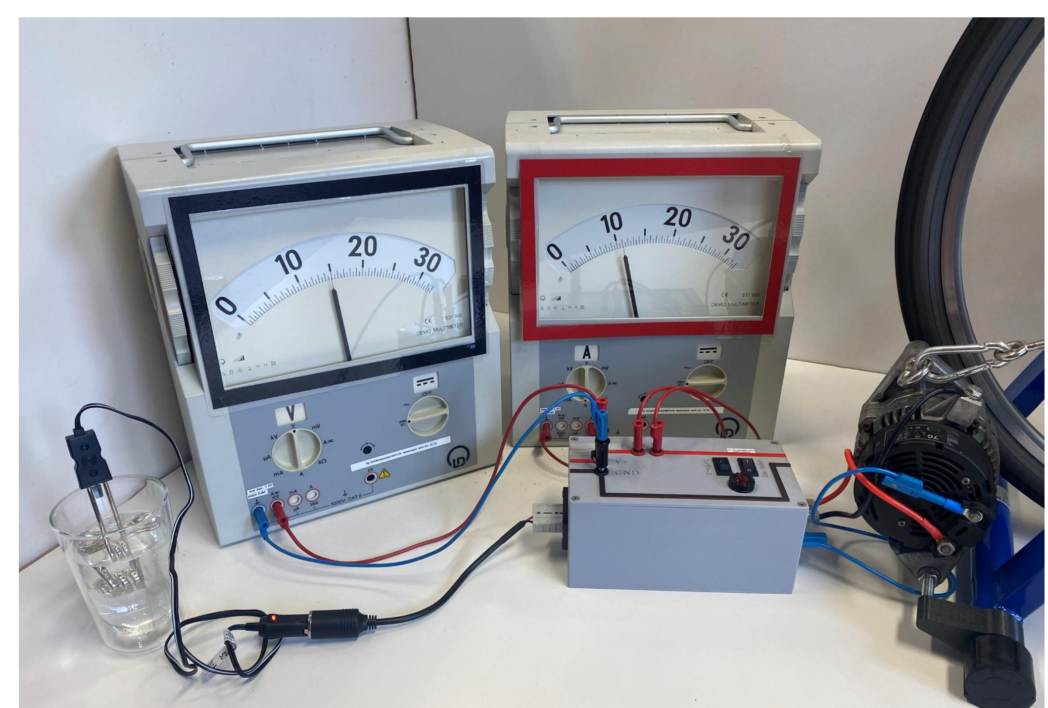
Die Abbildung zeigt die Strom- und Spannungsmessung an einem 110W-Camping-Tauchsieder, angetrieben vom Energiefahrrad.
