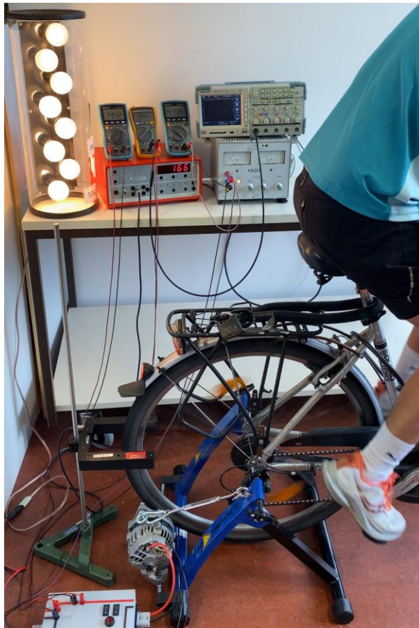
Abbildung 6-15: Betrieb einer ungeregelten Lichtmaschine am Zubehör des Oekotrainers
