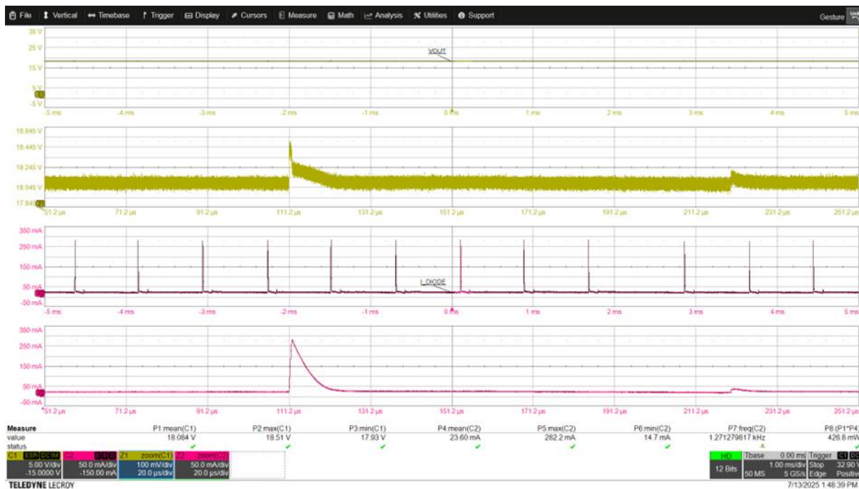
Abbildung 6-6: Oszillogramm zur Überprüfung der TVS-Schutzdiode
