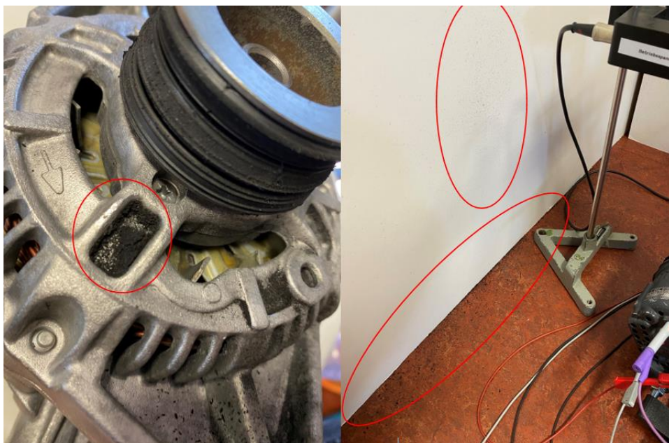
Abbildung 6-1: Foto vom Gummiabrieb mit gummierter Keilrippenriemenscheibe als Laufrolle
