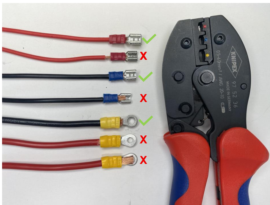
Abbildung 5-25: Crimpen von isolierten Kabelschuhen
