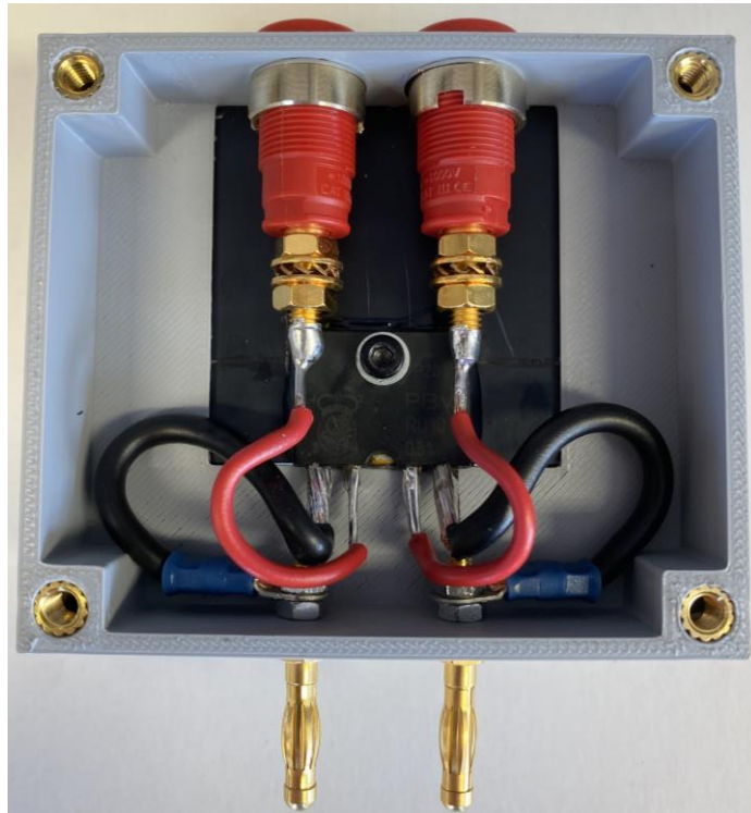
Abbildung 5-38: Löten der Einzeladern an die Sicherheits-Laborbuchsen
