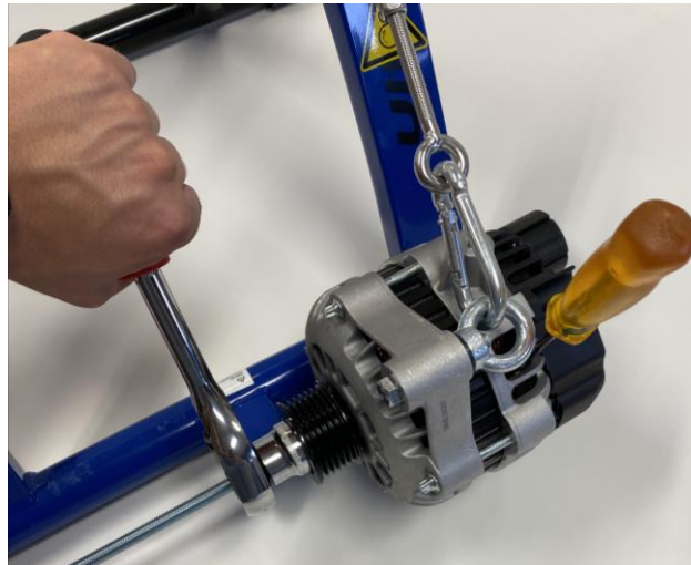
Abbildung 5-14: Demontage der Riemenscheibe
