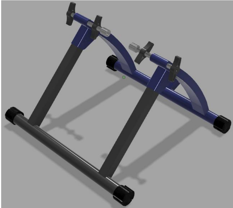
Abbildung 4-1: Gerendertes CAD-Modell des Rollentrainers ohne Bremsrolle
