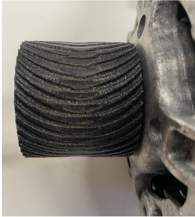
Abbildung 6-2: Foto der 3D-geruckten Laufrolle nach zahlreichen Versuchen
