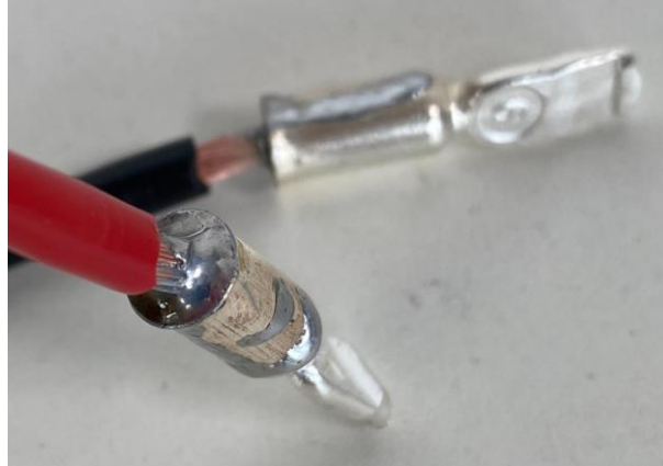
Abbildung 5-23: Gelötete Anderson Kabelschuhe
