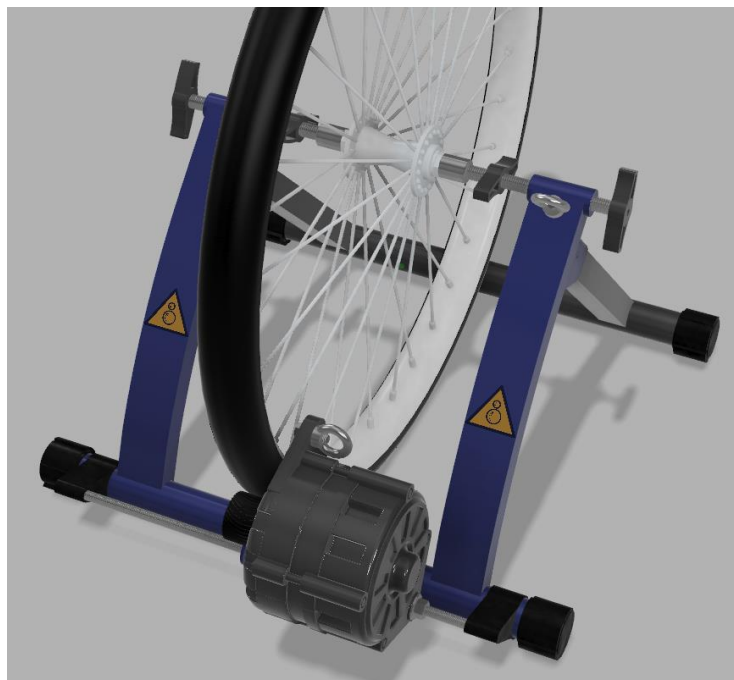
Abbildung 4-14: Gerendertes CAD-Modell der vollständigen mechanischen Konstruktion ohne Seilspanner
