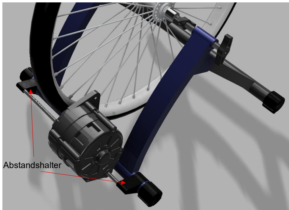
Abbildung 4-9: Gerendertes CAD-Modell des Rollentrainers mit M10-Gewindestange, Lichtmaschine, 28-Zoll Fahrradreifen und Abstandshaltern
