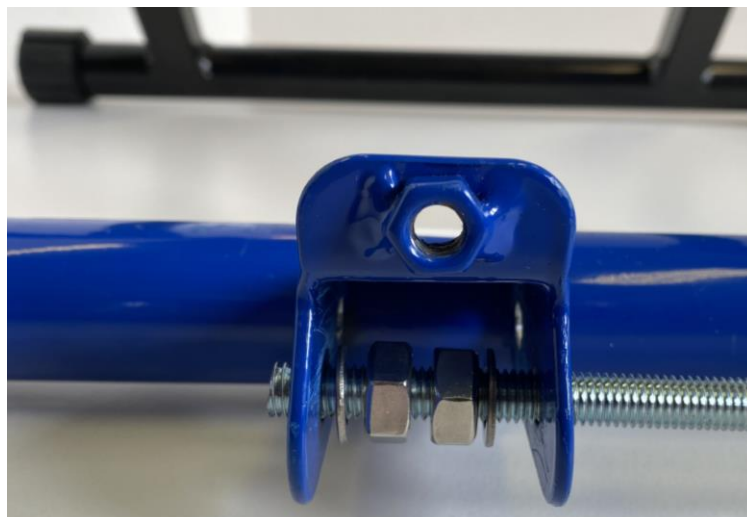
Abbildung 5-3: Einführen der Gewindestange in den U-Stahl
