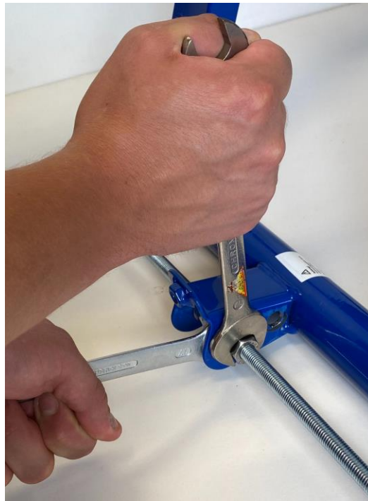
Abbildung 5-6: Verspannen der Muttern am U-Stahl
