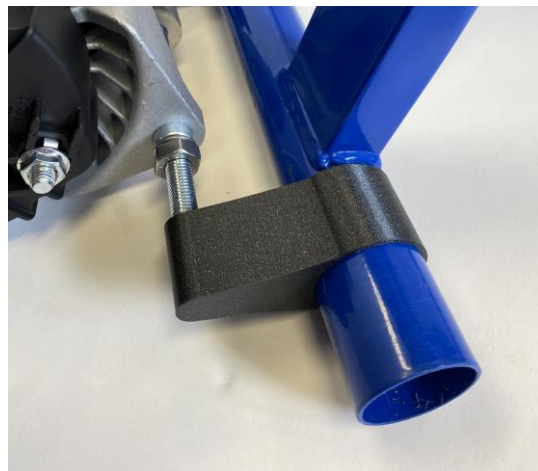
Abbildung 5-9: Montage der Abstandshalter
