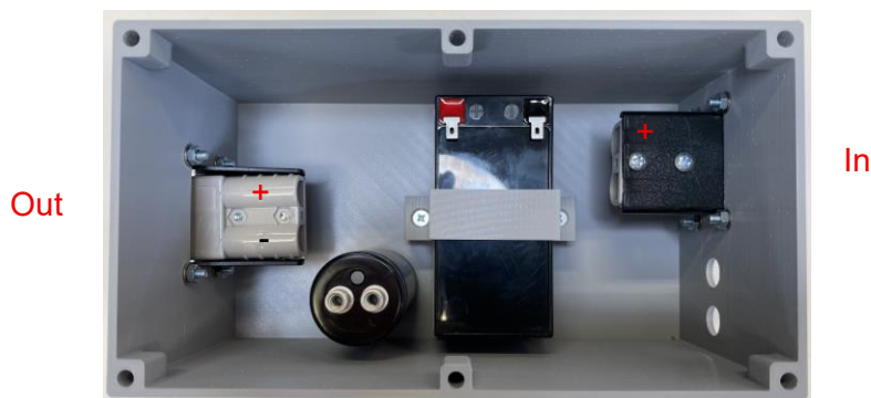
Abbildung 5-19: Elektrobox mit Batterie, Batterieklemme und Anderson-Steckdosen
