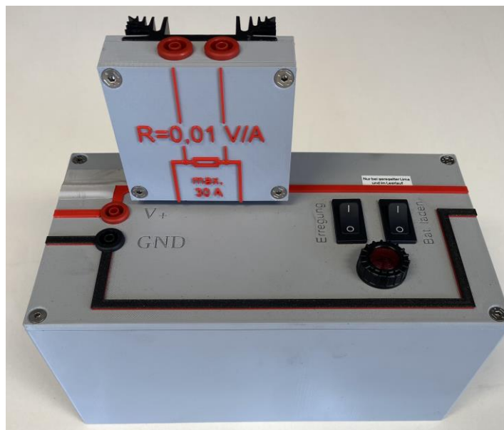
Abbildung 5-39: In die Elektrobox eingesteckter Shunt
