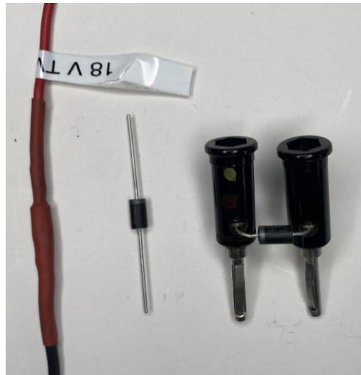
Abbildung 5-26: Anschlussmöglichkeiten der TVS-Schutzdiode; Bedrahtete Diode mit Schrumpfschlauch (links); Schutzdiode (Mitte); Schutzdiode in zwei Leybold-Klemmsteckern (rechts)
