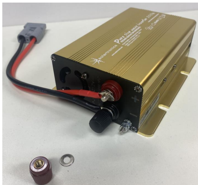
Abbildung 5-30: Anschluss des Wechselrichters
