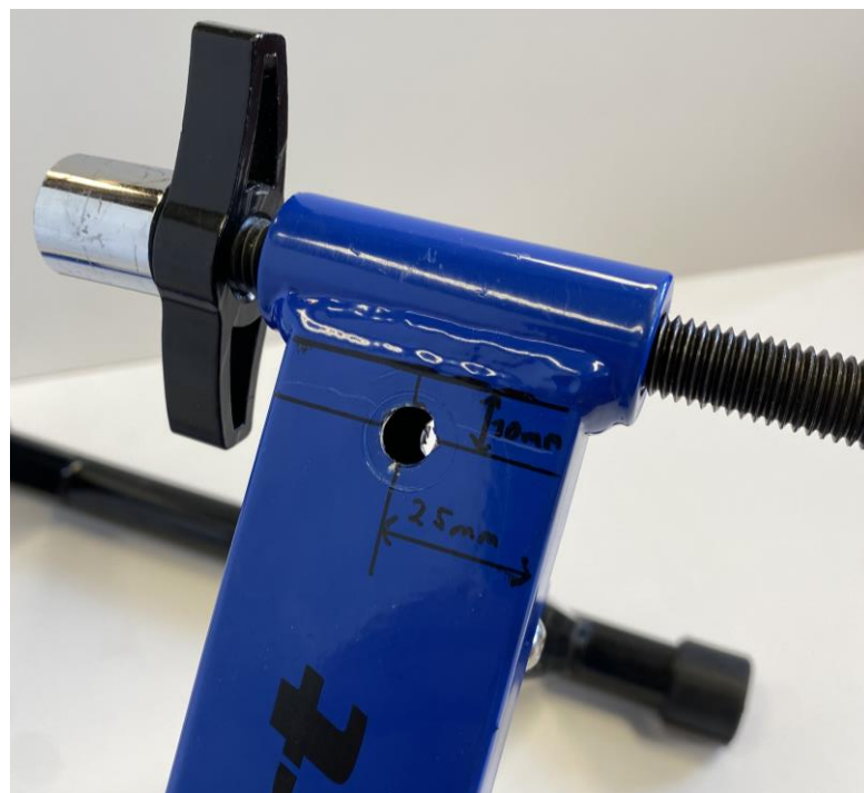
Abbildung 5-11: Bohrloch für Ringmutter im Holm des Rollentrainers
