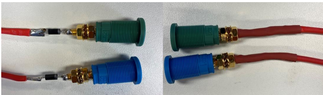
Abbildung 5-20: Einlöten der Erregerdioden
