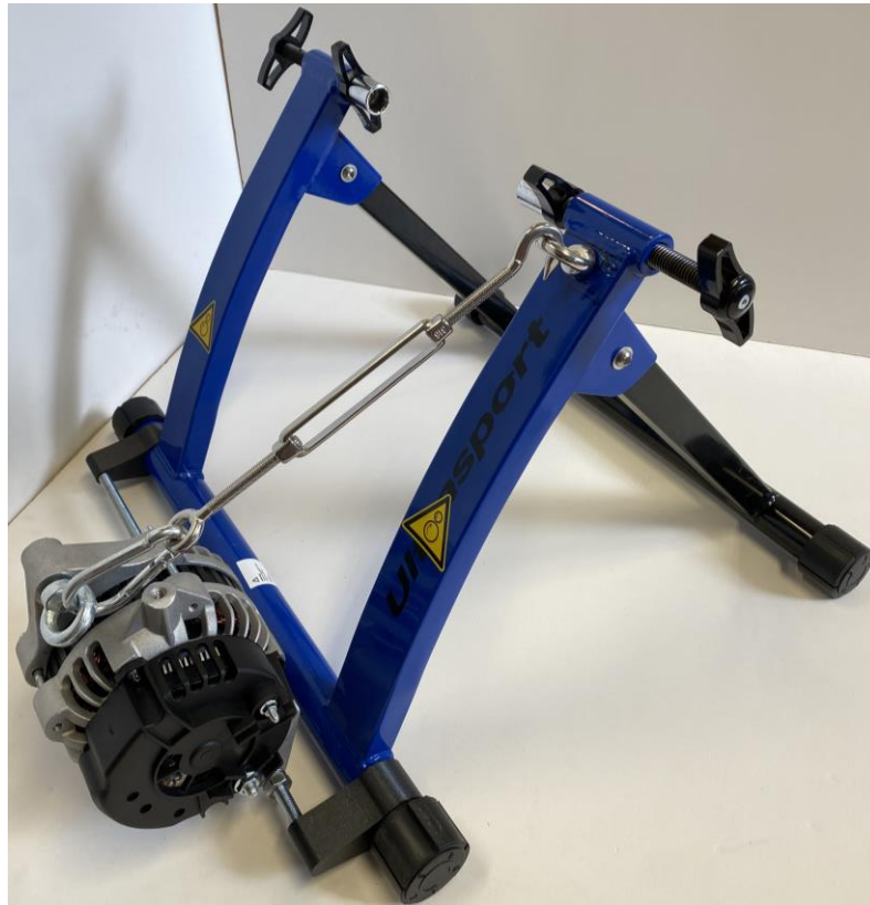
Abbildung 5-13: Fertige mechanische Konstruktion des Energiefahrrades
