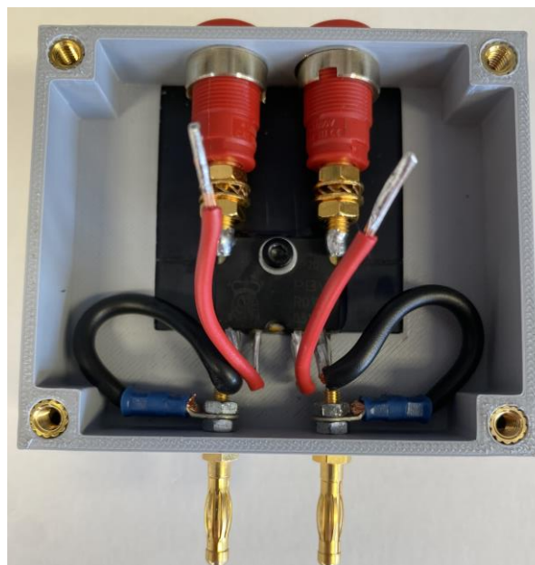
Abbildung 5-37: Verbinden M3-Ringkabelchuhe mit den Bananensteckern
