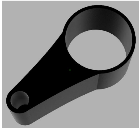
Abbildung 4-8: Gerendertes CAD-Modell des Abstandshalters
