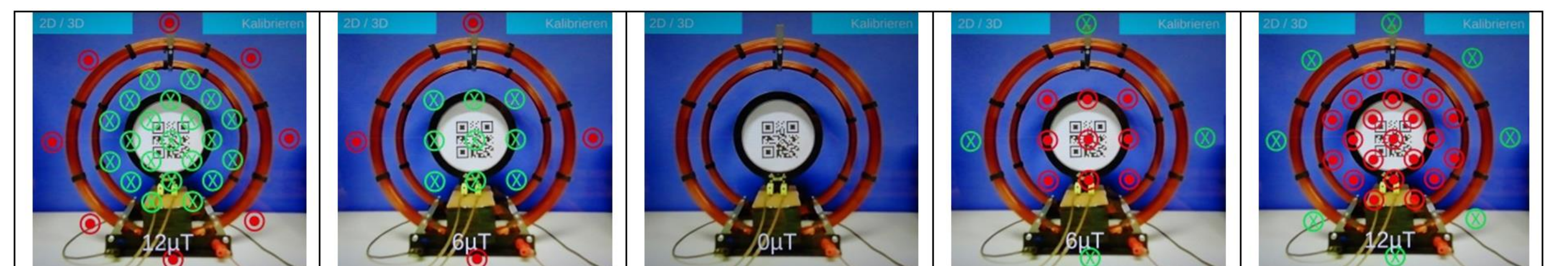
Abb. 3: Zeitliche Veränderung der mit Augmented Reality den Spulen überlagerten Feldlinien entsprechend der angelegten Wechselspannung in Analogie zu Abb. 1.
