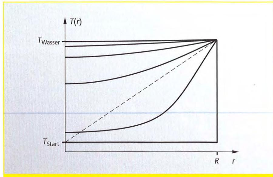
Abb. 1: Temperaturverlauf im kugelförmigen Ei mit Radius  $R$  für verschiedene Zeitpunkte nach dem Einlegen in heißes Wasser. Gestrichelt ist die verwendete zeitunabhängige Näherung für den Temperaturverlauf dargestellt.  $T_{\text{Start}}$  bezeichnet die Temperatur des Eies unmittelbar vor dem Einlegen in das heiße Wasser.
