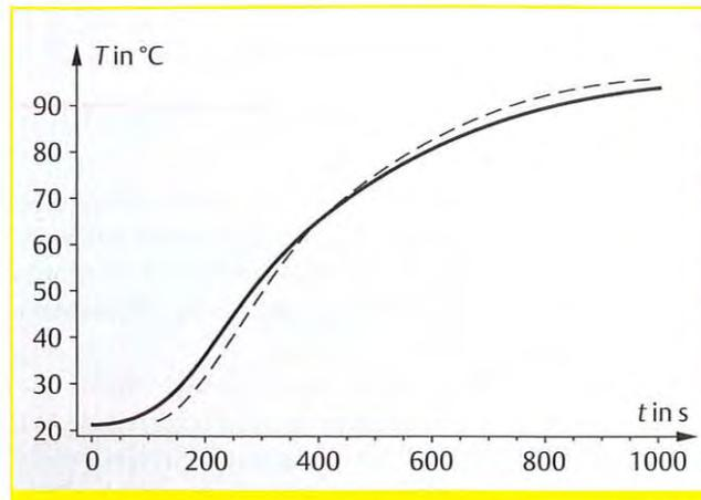
Abb. 3: Temperaturverlauf des Eies „Nr. 3“. Die Messung wurde unmittelbar nach dem Einlegen gestartet. Die Gerinnungstemperatur von 68 °C wurde nach 430 s erreicht. Gestrichelt ist das theoretische Ergebnis unter Annahme eines kugelförmigen Eies dargestellt, welches weiter unten im Text beschrieben wird.
