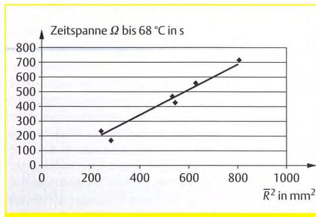
Abb. 4: Gemessene Zeitspannen bis zum Erreichen der Gerinnungstemperatur des Eigelbs aufgetragen gegen das Quadrat des mittleren Radius. Die Werte liegen näherungsweise auf der Ausgleichsgeraden durch den Nullpunkt. Dies entspricht der in unserer Abschätzung erwarteten Abhängigkeit. Die Ausgleichsgerade (in Sekunden) ist durch  $\Omega = 0,8578 \bar{R}^2$  gegeben. Der mittlere Radius ist dabei in Millimetern anzugeben.
