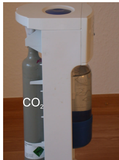
Abb. 2: Bestandteile eines Sodageräts. Links befindet sich die mit Kohlendioxid gefüllte Kartusche, rechts eine mit Wasser gefüllte Flasche.
