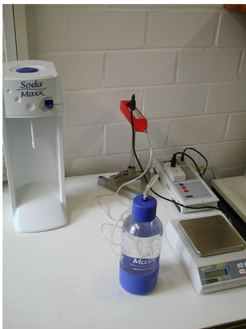
Abb. 9: Versuchsaufbau zur Messung des Zusammenhangs zwischen der gelösten Menge an Kohlendioxid und dem resultierenden Gleichgewichtsdampfdruck. Mithilfe eines Schlauches wird die Wasserflasche an das Druckmessgerät von Leybold (2000hPa) angeschlossen, sodass der Druck über das CASSY-Interface vom Computer registriert werden kann. Die Digitalwaage rechts neben der Flasche dient zur Bestimmung der gelösten Masse an Kohlendioxid.
