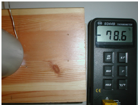
Abb. 5: Abkühlen des Kohlendioxids beim Ausströmen. Die Kartusche (links im Bild) wird mit dem Ventil auf einen Nagel gedrückt, der vorher in ein Brett eingeschlagen wurde. Das ausströmende Kohlendioxid ist sehr kalt. Die Temperatur wurde mit Hilfe eines NiCr-Ni-Thermometers (Metalldraht oben links) gemessen, welches ausreichend schnell reagiert.
